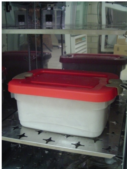
Figura 4. Cámara Húmeda. Tenemos una vista lateral de la cámara utilizada para evitar la evaporación del agua en las cajas Petri a 60 °C.
