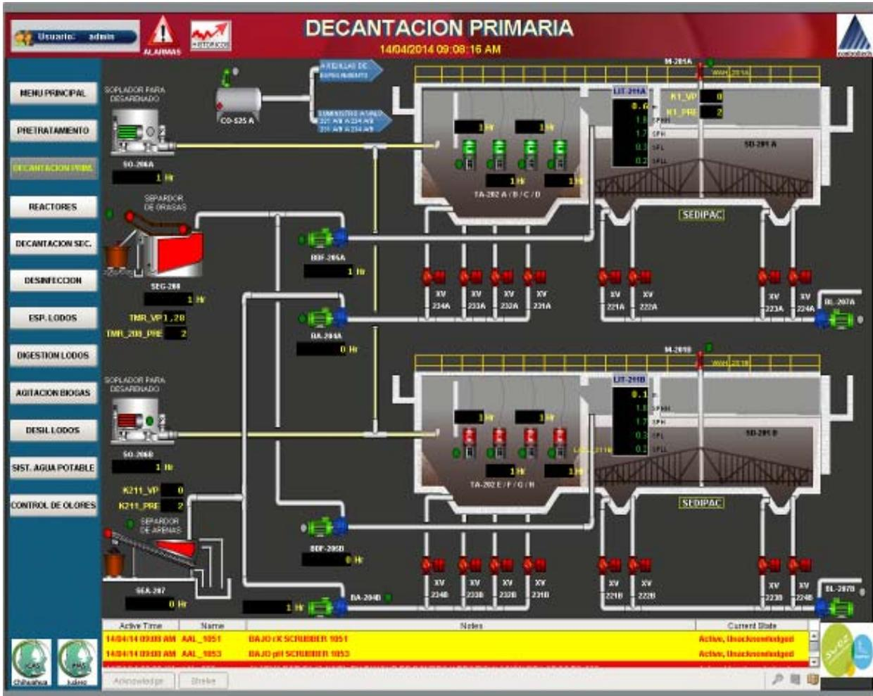
**Figura 2.17 Pantalla en estación de control.**
