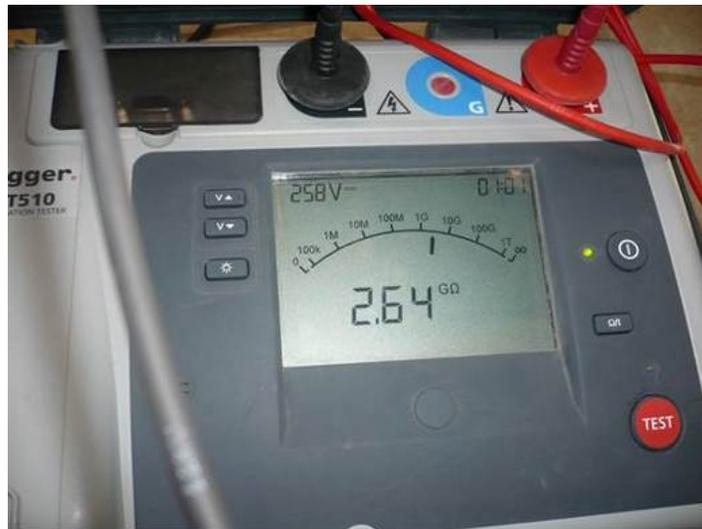
**Figura 5.3 Medición de resistencia de aislamiento en GigaOhm.**
