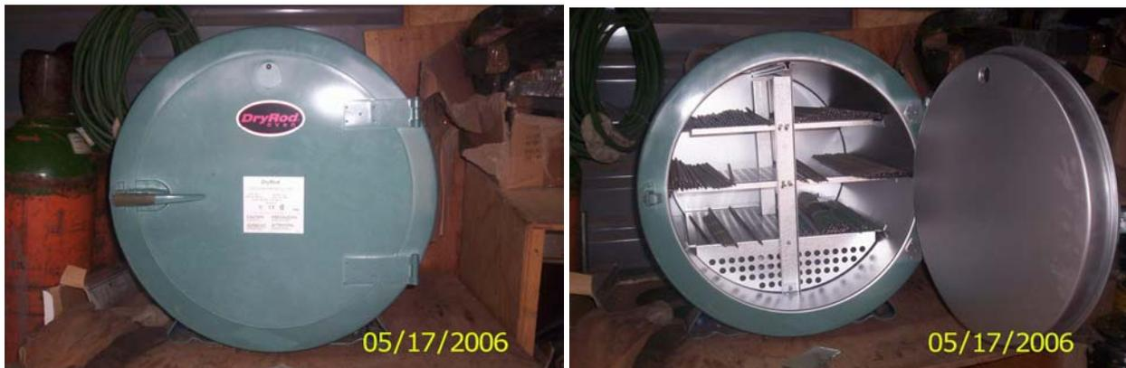
**Figura 4.10 Horno estacionario para electrodos de soldadura**
