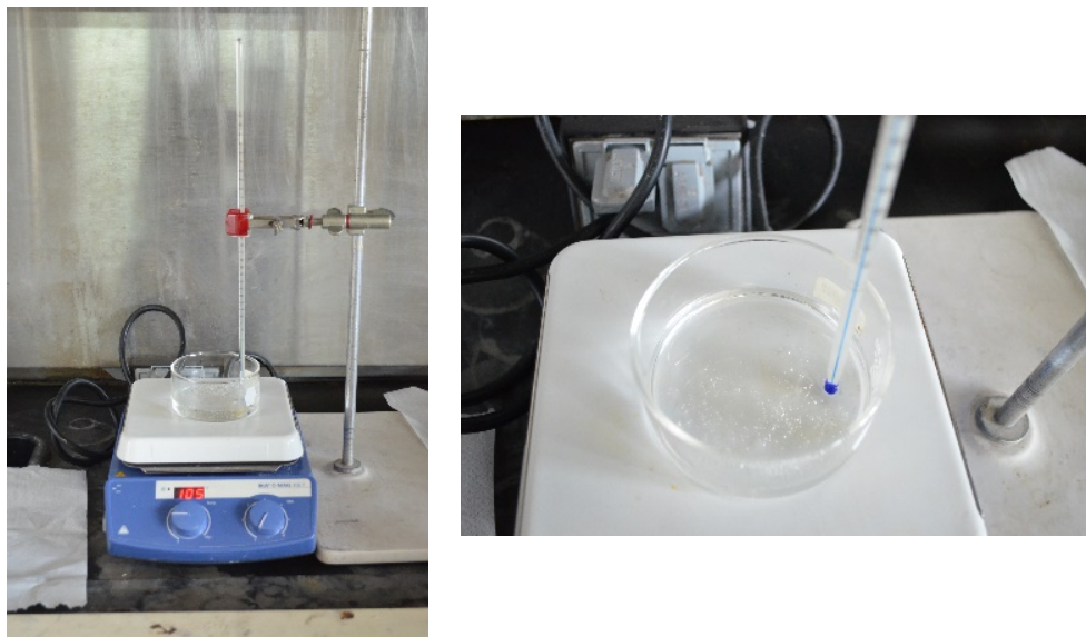
Figura 3.4. Activación de membrana Nafion® 115.
