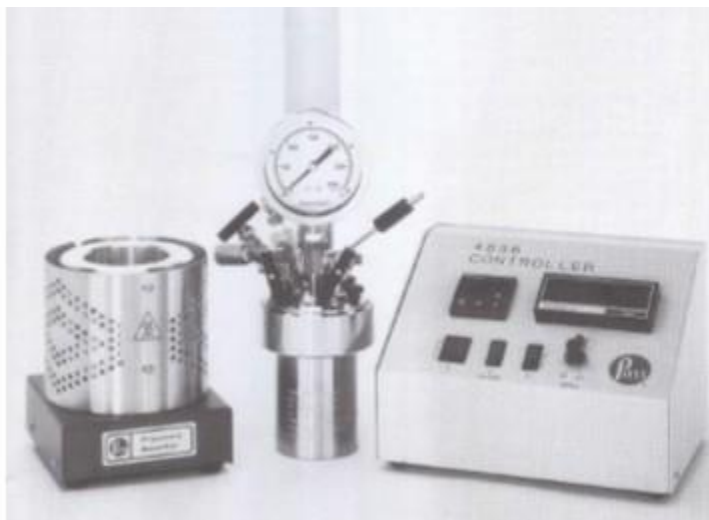
Figura 3.1 Reactor empleado para la evaluación del catalizador.
