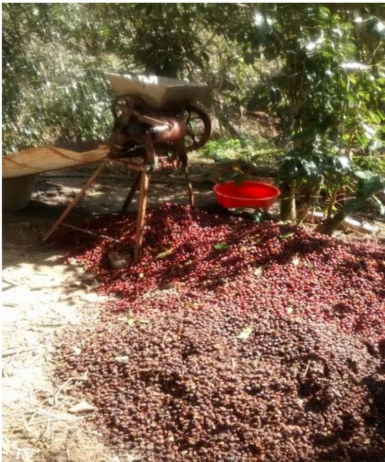
Fotografía 4. Molino manual para despulpar el café.
