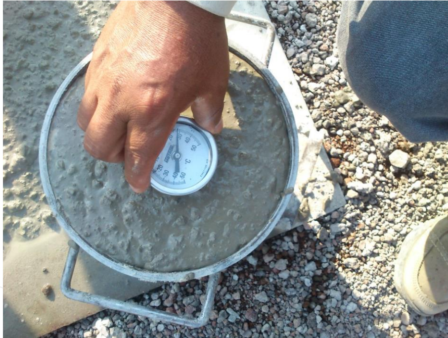
Ilustración 103. Verificaba la temperatura una vez por colado.
