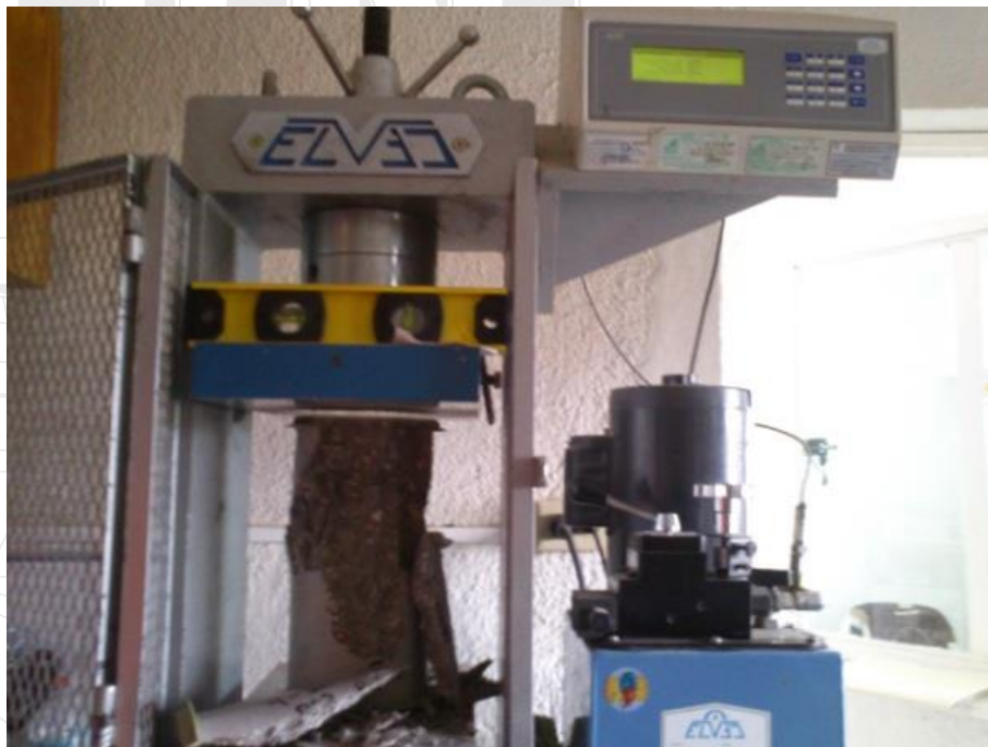
Ilustración 113. La resistencia del concreto endurecido es válida cuando supera los 480Kg/cm 2 .
