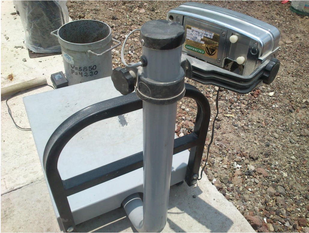
Ilustración 27. Verificación de etiqueta de calibración de Báscula Digital, durante pruebas de concreto fresco.
