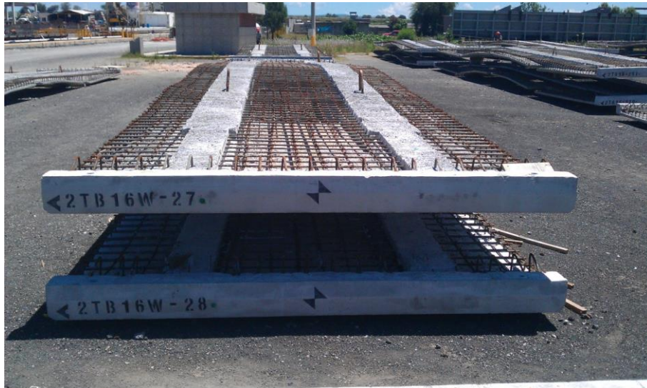
Ilustración 131. Por último, verifico el eje de fabricación, la nomenclatura y la orientación que corresponda con el plano de localización.
