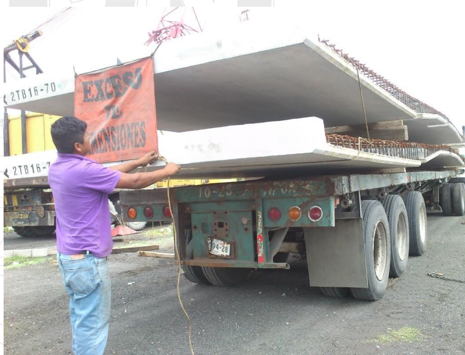
Ilustración 136. Operador del transporte, colocando señalamientos de seguridad y prevención.
