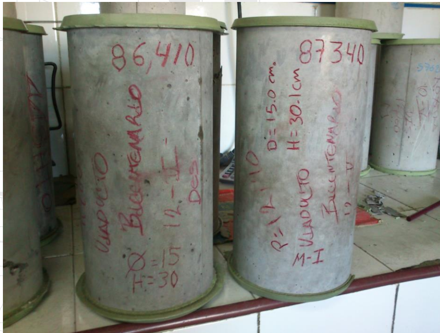
Ilustración 111. Los especímenes son de 30cm de altura y 15cm de diámetro.
