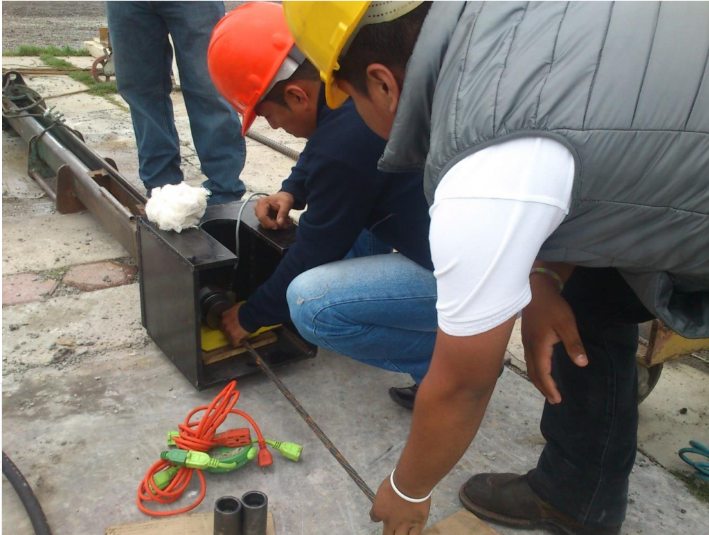
Ilustración 17. Calibración del gato de tensado, probado con un torón de 1/2" de diámetro.
