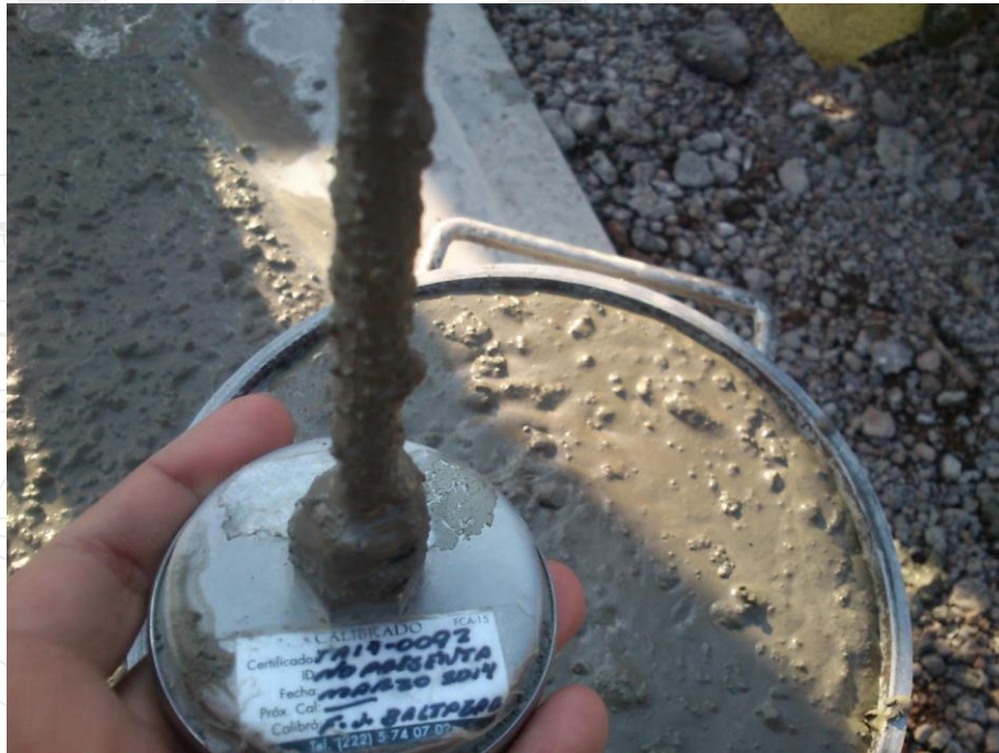
Ilustración 104. Verifico la calibración del termómetro.
