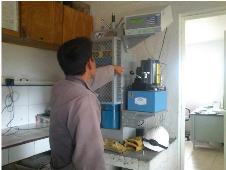
Ilustración 112. Superviso el ensayo a compresión.
