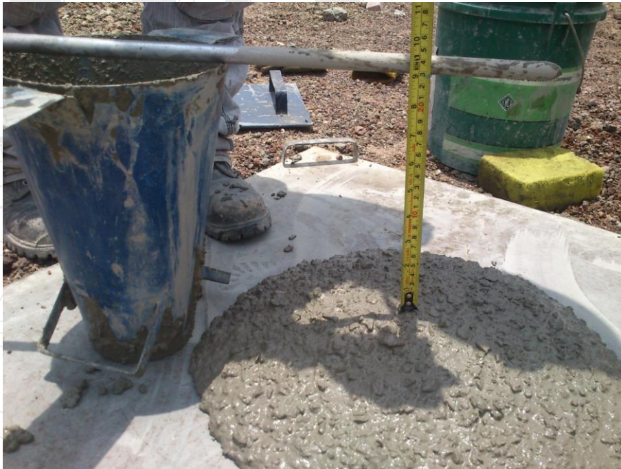
Ilustración 96. Superviso el revenimiento, que cumpla con el parámetro de acuerdo a proyecto, correspondiente a 24cm \pm 2.5cm.
