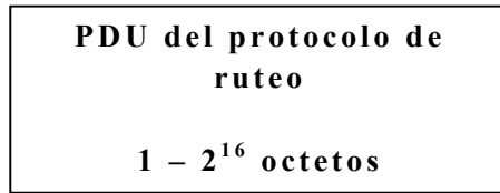
Figura 3.8 Formato del campo de carga de la subcapa CPCS para PDU's transportados con multiplexaje basado en canal virtual
