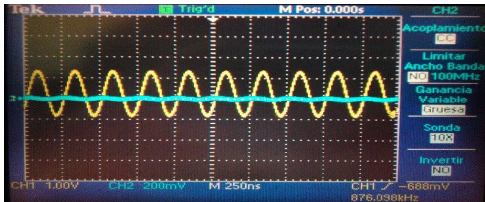
Figura 3.13 Señal de entrada de circuito comparada con la señal a la salida de la segunda fase con una frecuencia de trabajo de 4 MHz.
