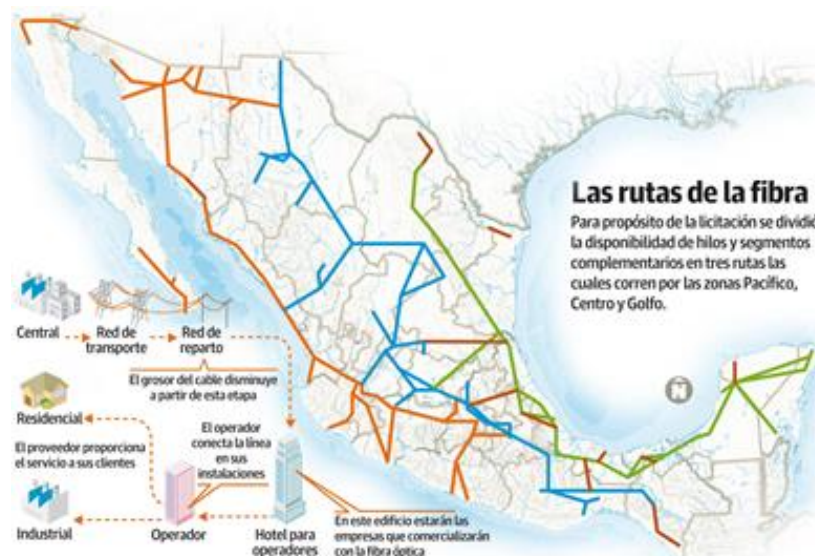
Ilustración 1. Red de fibra óptica
