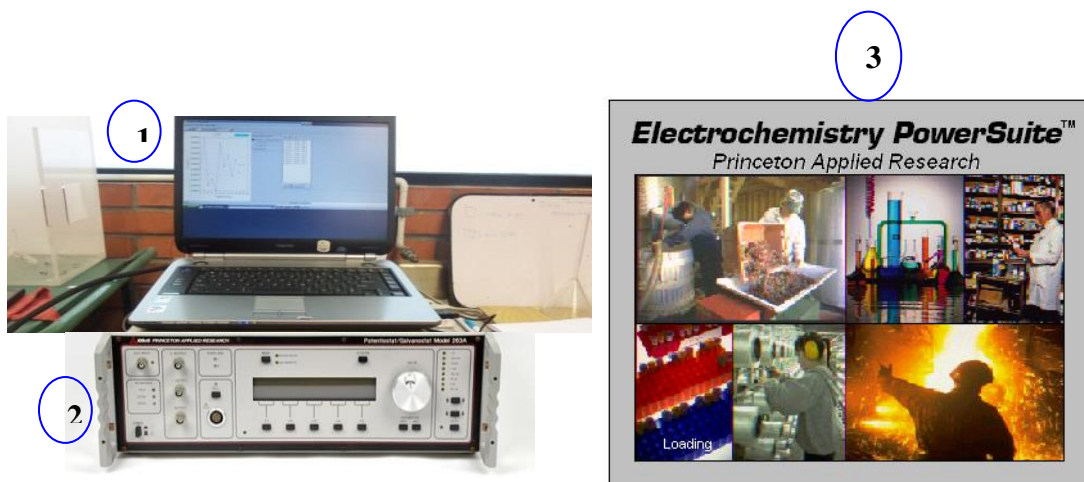
Figura 12. Equipo y programa utilizado para la prueba de Resistencia a la Polarización Lineal
