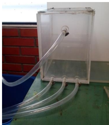
Figura 10. Arreglo de las mangueras para la cámara de pruebas
