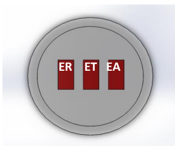
Figura 11. Arreglo de los cupones de acero.
