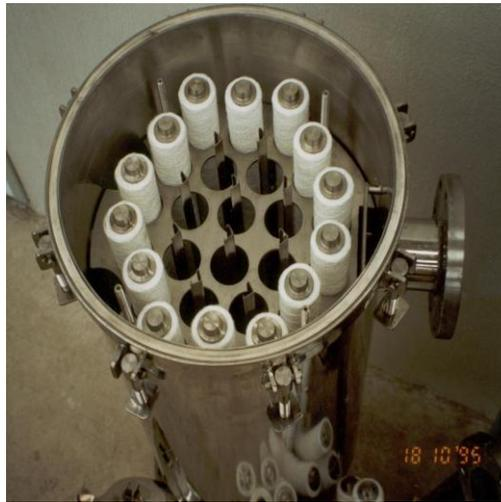
Figura II.3 se muestra un ejemplo de un filtro pulidor de cartuchos. <sup>(21)</sup>
