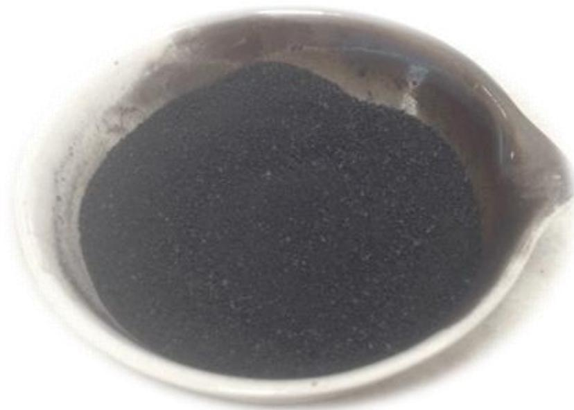
Figura 18. Aspecto del Biochar obtenido por pirólisis (tratamiento T4) en mufla a partir de lodos residuales.
