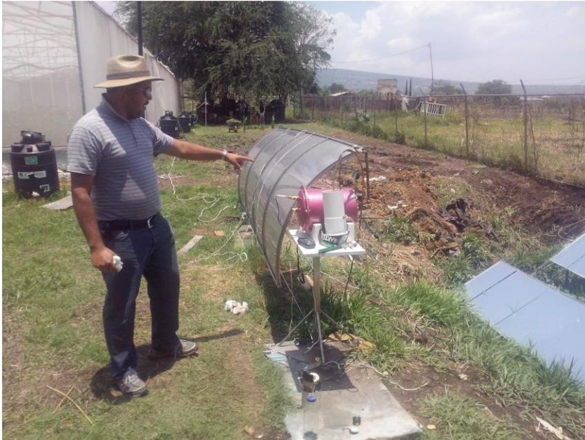
Figura 15. Sistema térmico para generar Biochar por pirólisis.
