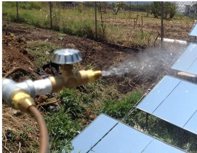
Figura 17. Termopar utilizado para la medición de la temperatura interna en el dispositivo y válvulas de control de temperatura y presión.
