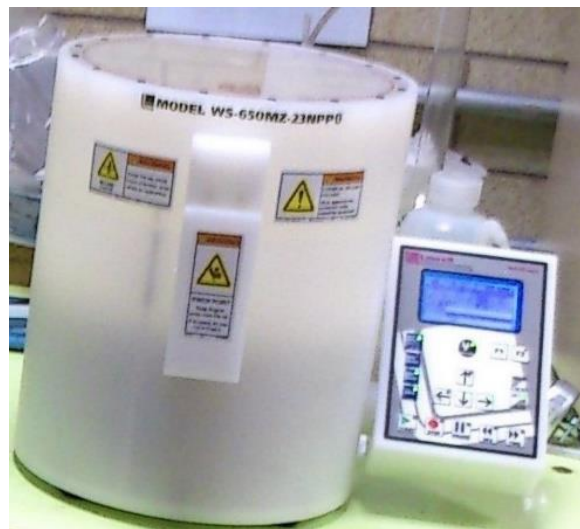
Figura 3.3. Equipo spin-coater en donde se depositaron las películas FTO por spin-coating.
