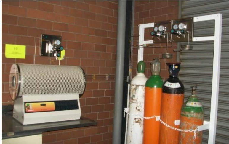
Figura 3.7. Esquema del horno y el sistema de alimentación de gases para las pruebas de corrosión
