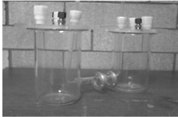
Figura 42. Celda de acuerdo a norma ASTM G148-97.
