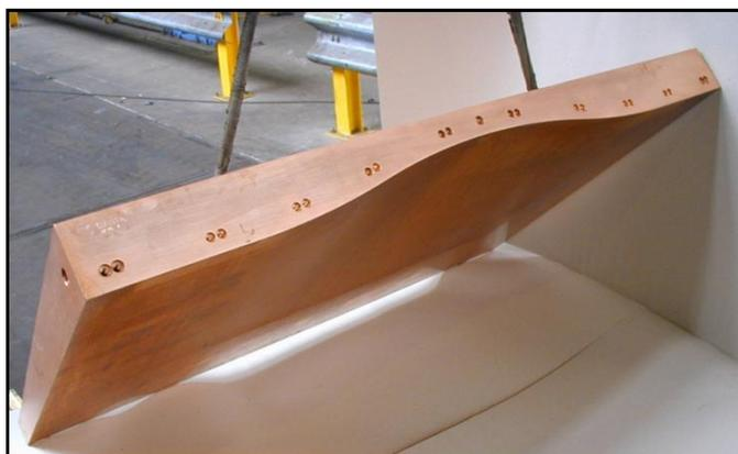
Figura 3. Geometría del molde utilizado en colada continua para planchón delgado.
