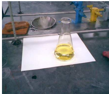
Fig. 4.3 después de la titulación queda de un color amarillo pálido
