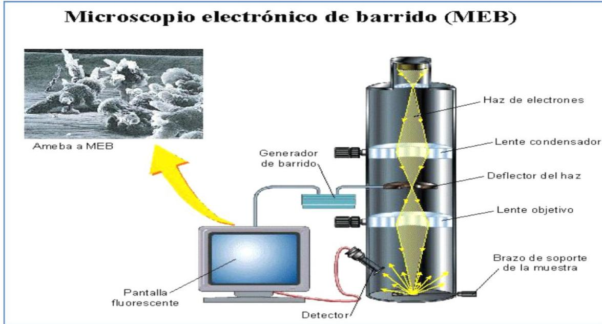
**Figura II.3- Esquema de un Microscopio Electrónico de Barrido.**
