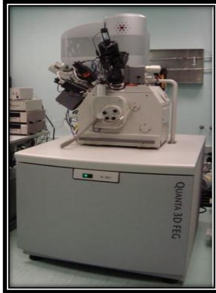
**Figura II.5- Microscopio Quanta 3D FEG (marca FEI)**
