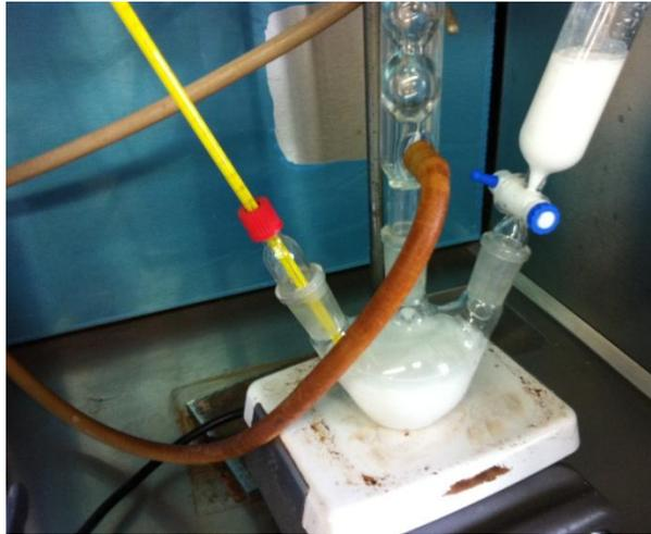
Figura III.1 – Sistema para la preparación de MgO/CaO
