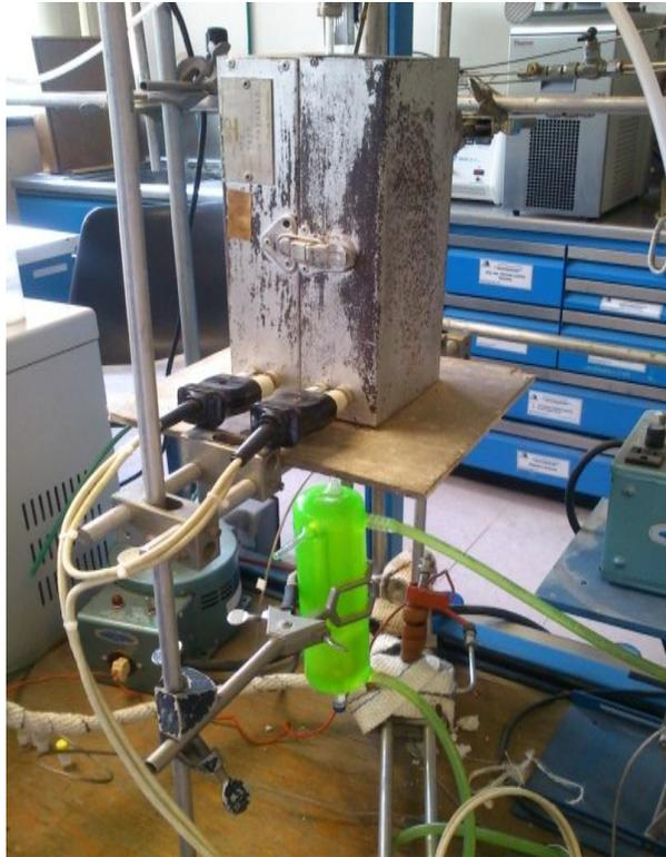
**Figura III.8– Microplanta de condensación aldólica**
