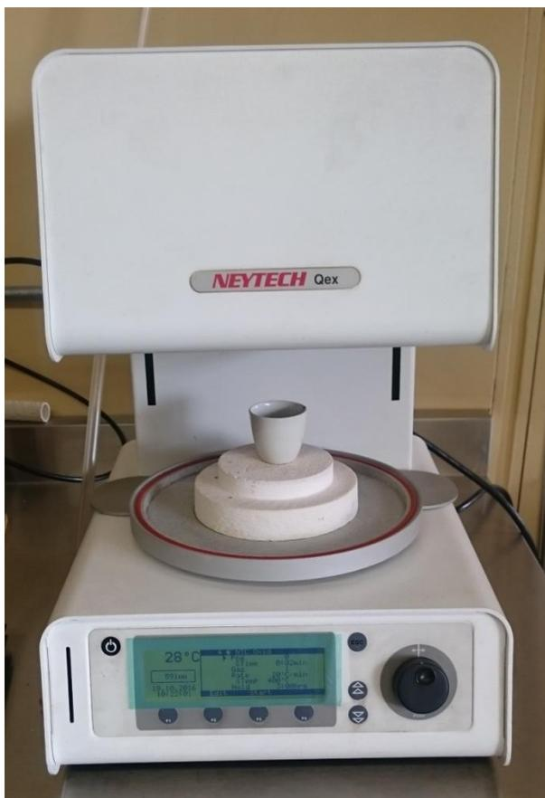
Figura 2.2.4 Horno de ambiente controlado marca NEYTECH Qex.
