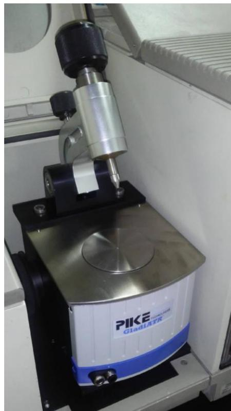
*Figura 2.3.2 Accesorio ATR utilizado en las mediciones de las muestras.*
