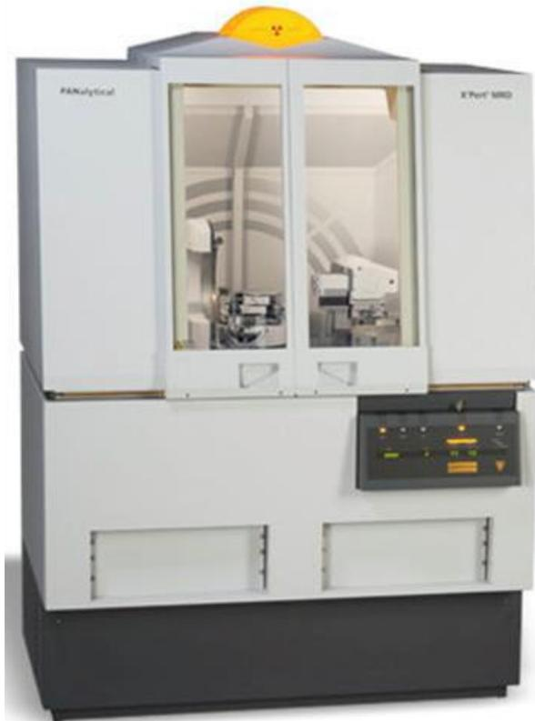
*Figura 2.3.1 Difractómetro marca PANalytical modelo X pert PRO MRD*
