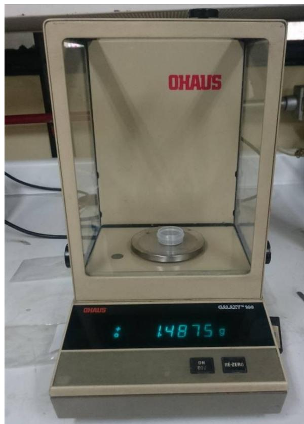
Figura 2.2.1 Balanza analítica marca OHAUS, donde son pesadas cada una de las muestras de nanoestructuras de carbono.
