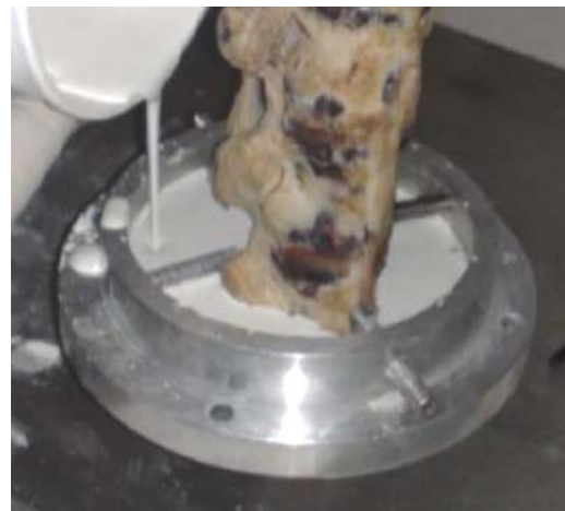
Figura 3.25. Copas de aluminio para el ensayo a tracción de los especímenes lumbares porcinos.
