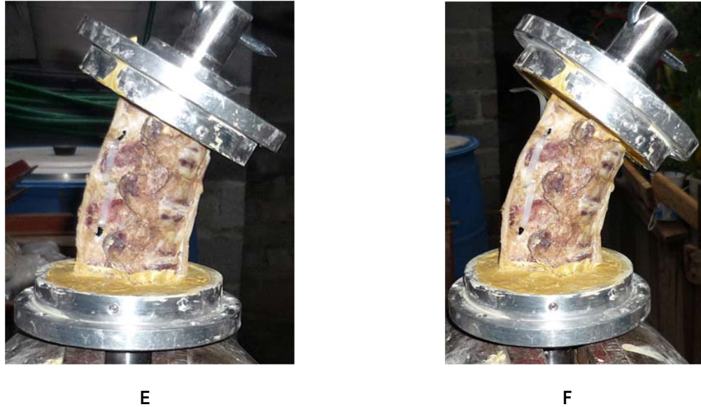
Figura 3.64. Espécimen lumbar porcino (5) de L1-L4 con la colocación del cinturón de poliamida 6/6 entre apófisis espinosas L2-L3. (E). Ángulo del plato a 26°, sin daño en sujeción del cinturón de poliamida 6/6. (F). Ángulo del plato a 30°, con daño en sujeción del cinturón de poliamida 6/6.
