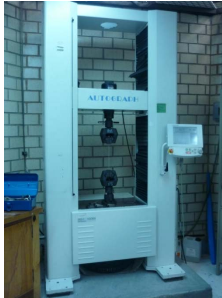
Figura 3.77. Máquina de ensayos universal – prensa servomecánica Shimadzu, con Cap. de 100 KN.
