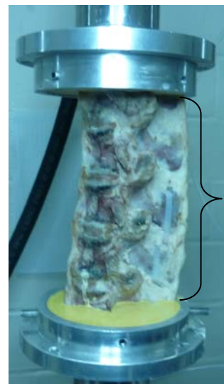
Fig. 5. Curvatura producida por el plato de aluminio a 10°.
