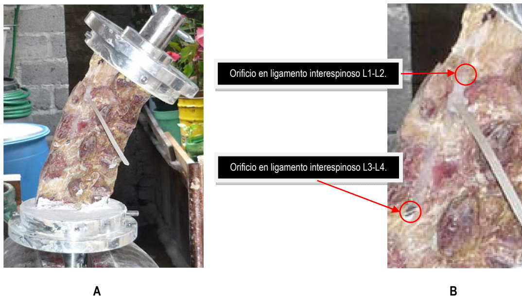
Figura 3.68. Espécimen 2 lumbar porcino de L1-L5 con la colocación del cinturón de poliamida 6/6 entre apófisis espinosas L2-L3. (A). Espécimen porcino de L1-L5 con una carga de 8 kg (78.48 N) momentos antes de dañar el cinturón de poliamida 6/6. (B). Orificios en los ligamentos interespinosos entre L1-L2 y L3-L4 a una carga de 8 kg (78.48 N) momentos antes de fallar el cinturón de poliamida 6/6.
