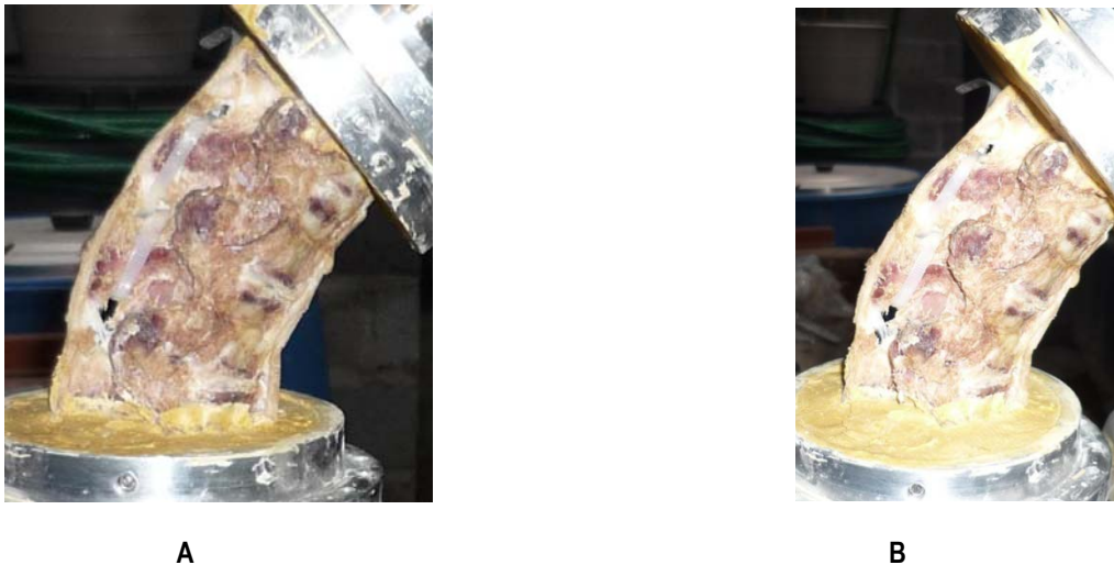
Figura 3.71. Especimen 5 lumbar porcino de L1-L5 con la colocación del cinturón de poliamida 6/6 entre apófisis espinosas L3-L4. (A). Especimen porcino con una carga de 8 kg. (78.48 N) momentos antes de fallar. (B). Daño en ligamento interespinoso de L3-L4 y daño en ligamento interespinoso de la misma zona, con daño en unión del cinturón de poliamida 6/6.
