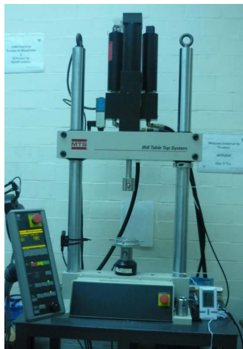
Figura 3.23. Máquina de Ensayos Universal MTS 858 Cap. de 5 Ton.
