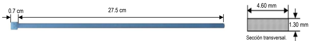
Figura 3.3. Dimensiones del cinturón de poliamida 6/6 © Legrand [1]
