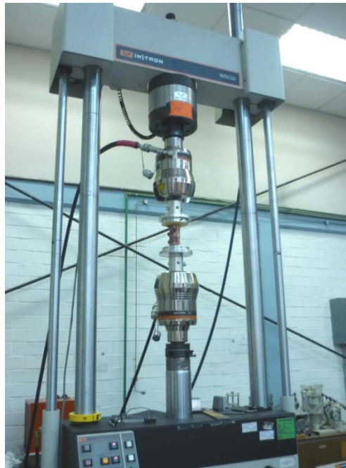
Figura 3.24. Máquina de Ensayos Universal INSTRON 8502 Cap. de 250 KN.
