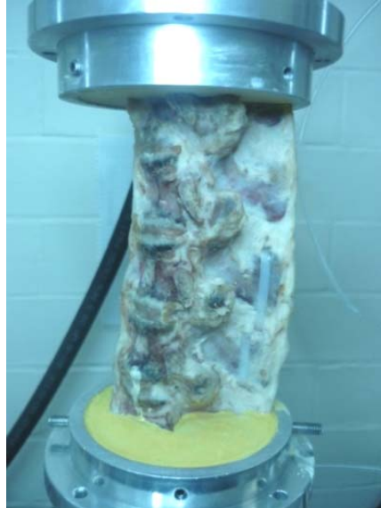
Figura 3.34. Espécimen lumbar porcino montado en copas de aluminio, con detalle del plato del mismo material con angulación a 10°.
