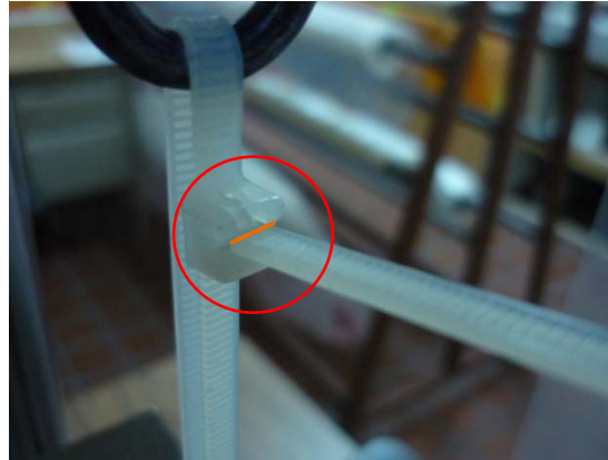
Figura 3.93. Marca a tope para el cierre del cinturón de poliamida 6/6 para el arreglo en “O”.
