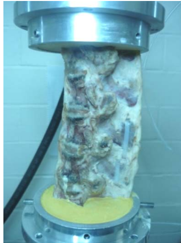
Figura 3.34. Especimen lumbar porcino montado en copas de aluminio, con detalle del plato del mismo material con angulación a 10^\circ .
