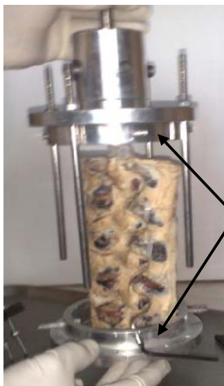
Figura 3.25. Copas de aluminio para el ensayo a tracción de los especímenes lumbares porcinos.
