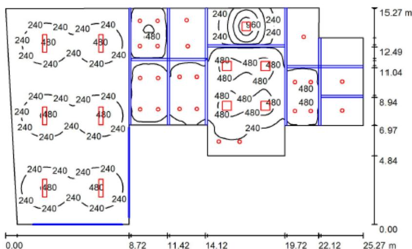
Altura del local: 2.800 m, Altura de montaje: 2.800 m, Factor mantenimiento: 0.80
