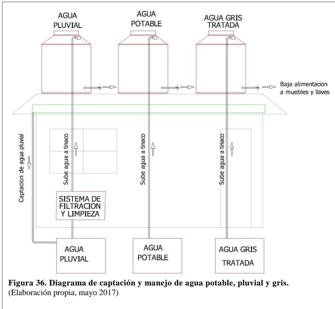
**Figura 36. Diagrama de captación y manejo de agua potable, pluvial y gris.**
