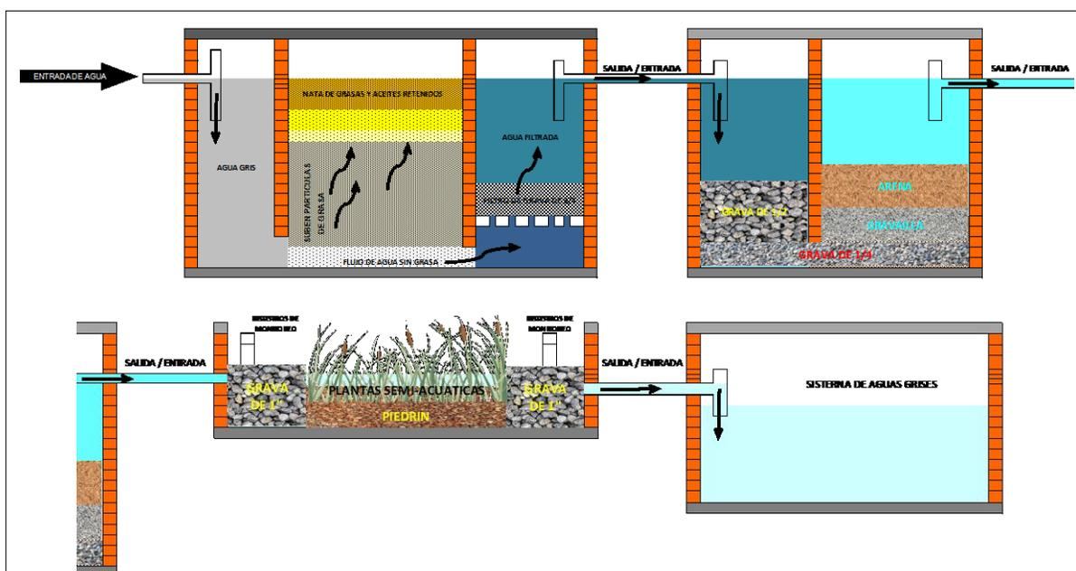
**Figura 38. Sistema de tratamiento de aguas grises y almacenamiento.**
