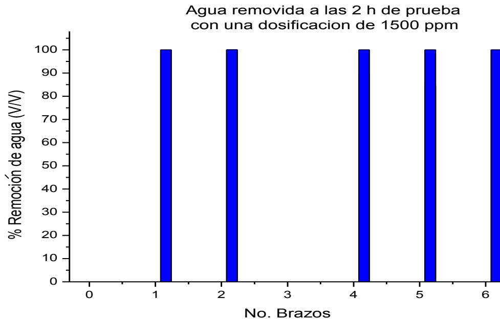
Figura 3.25: Remoción de agua a las 2 h de evaluación contra el número de brazos del agente deshidratante en la prueba de botella del crudo Cozcaapa (12.71 °API), con una dosificación de 1500 ppm a 80 °C.
