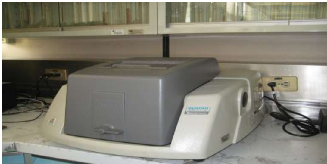
Figura 2.13: Equipo de FTIR utilizado en la Elucidación Estructural de las muestras analizadas del I.M.P., obteniéndose los diferentes espectros de FTIR.
