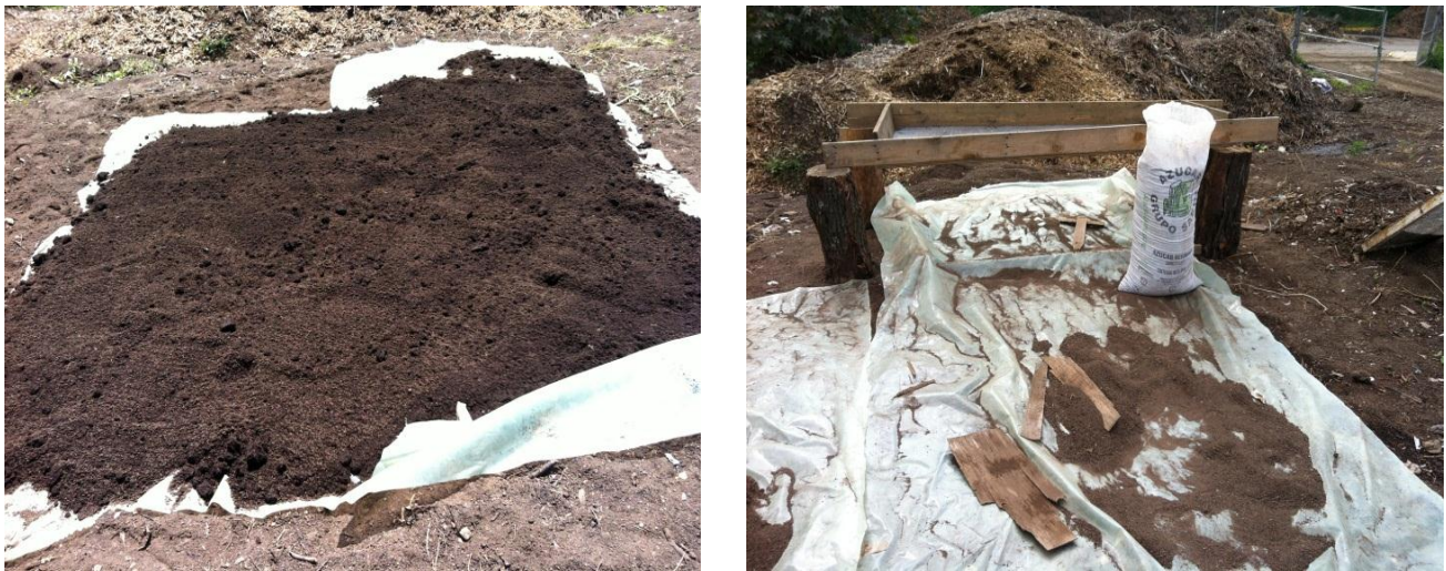
Figura 11. Proceso de preparación del suelo extraído sin contaminar. Suelo secado al aire (izquierda) y tamizado (derecha).
