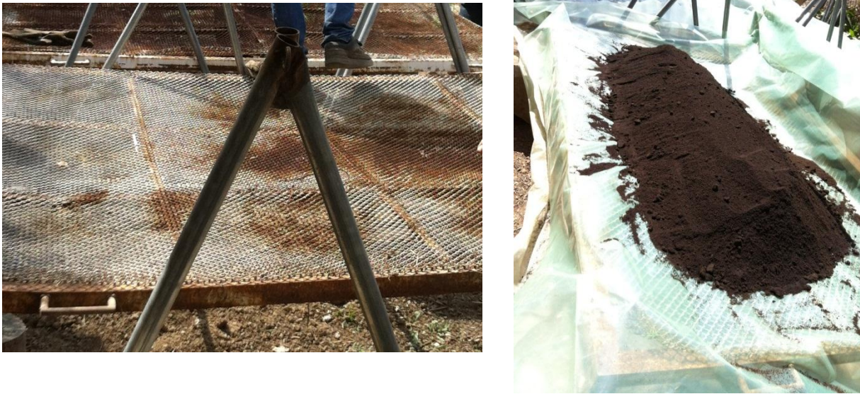
Figura 13. Construcción de biopilas experimentales puestas sobre bases de metal (izquierda) con cubierta de plástico para evitar pérdidas de suelo (derecha).
