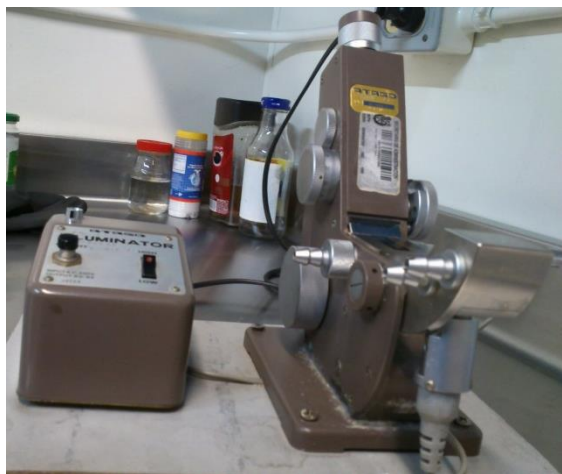
Figura 2. 7 Refractómetro Atago Illuminator empleado para las determinaciones del índice de refracción de los productos líquidos.
