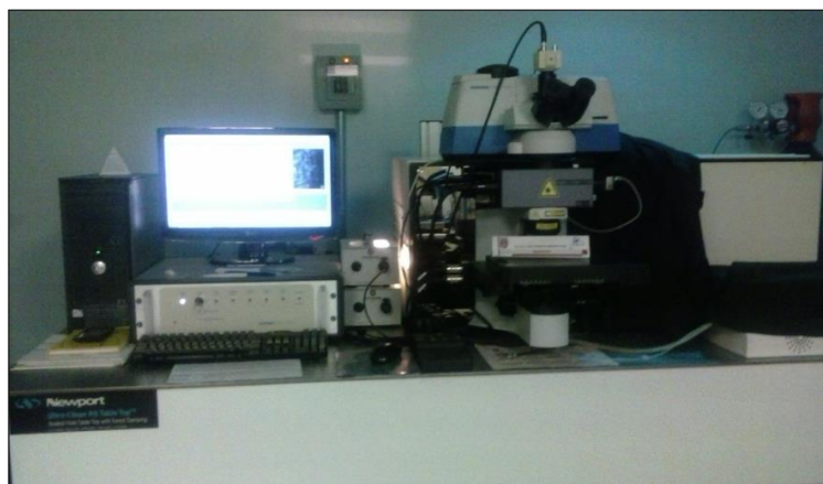
Figura 2.23 Espectrómetro Raman de la Marca Horiba Jobin Yvon modelo Labram HR800 con fuentes de excitación láser de 532 nm, 633 nm y 785 nm
