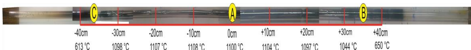
Figura 3.5 Evidencia de síntesis de la corrida experimental 4. Los sustratos de cuarzo se colocaron A = 0 cm, B = +33 cm y C = -37.5 cm.
