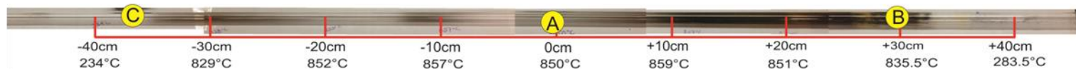
Figura 3.2 Evidencia de síntesis de la corrida experimental 1. Los sustratos de cuarzo se colocaron A = 0 cm, B = +29.5 cm y C = -37 cm.
