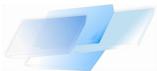
Figura 2.7 Sustratos de cuarzo de 5 mm x 5 mm y 2 mm de espesor.
