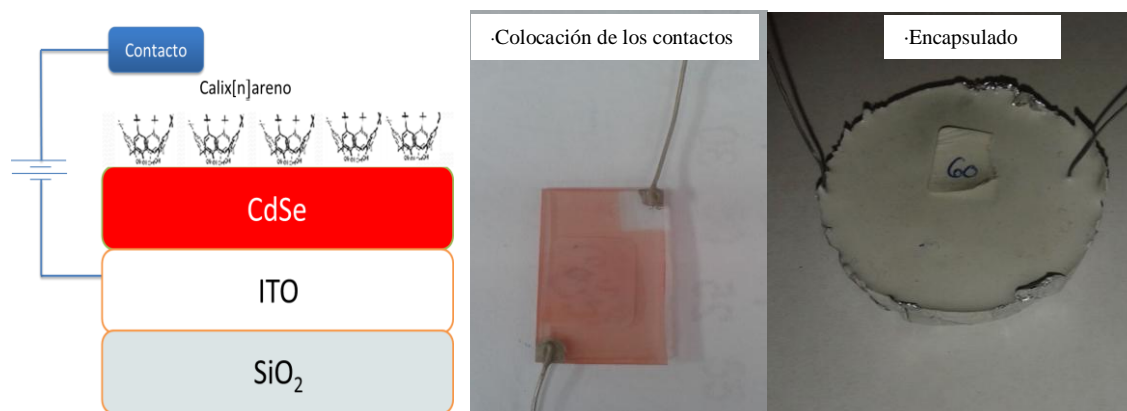
Figura. 15. Esquema del dispositivo propuesto como sensor químico y preparación de las muestras.
