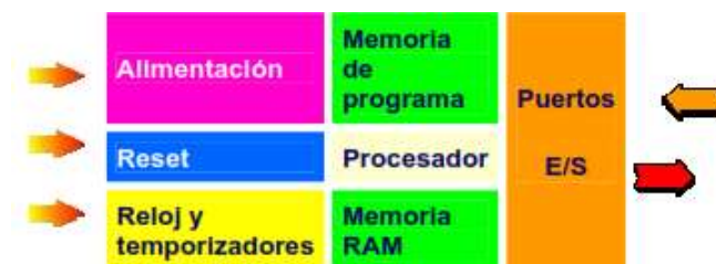
Fig. 12 Esquema de un microcontrolador
