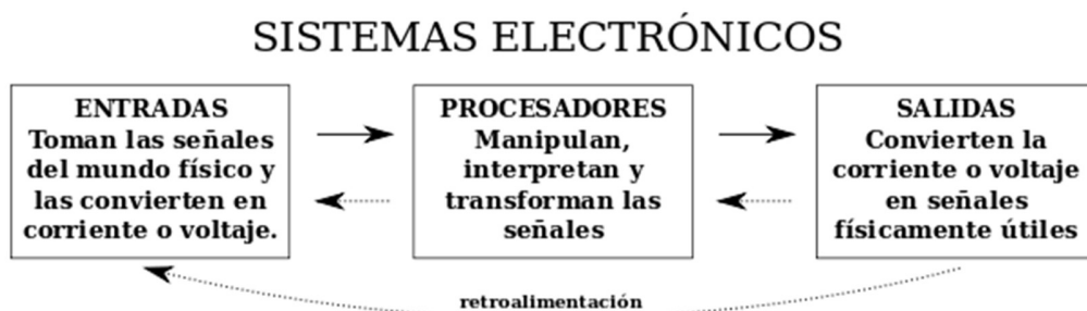
Fig. 11 Partes de un sistema Electrónico
