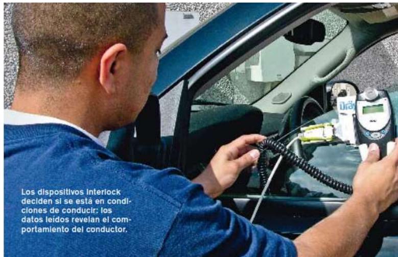
Fig. 4 Dispositivo Interlock para bloqueo.
