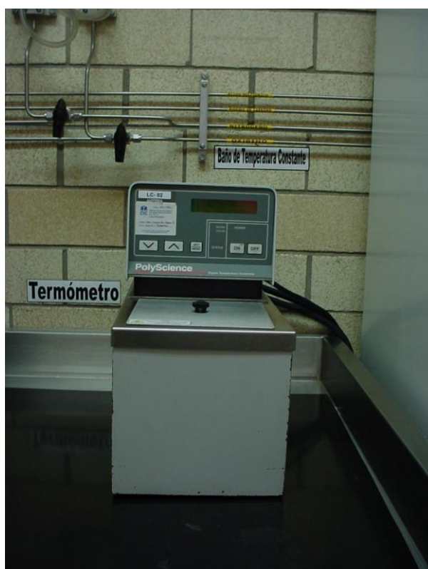
Figura 17.- Baño para el control de la temperatura PolyScience-Digital Temperature Controller marca PolyScience modelo 8001.
