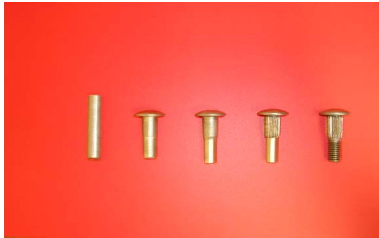
FIGURA 5-7 RESULTADOS OBTENIDOS DEL ENSAYO DE CONFORMADO EN FRIO DEL BIRLO DE ACERO INOXIDABLE TIPO 304
