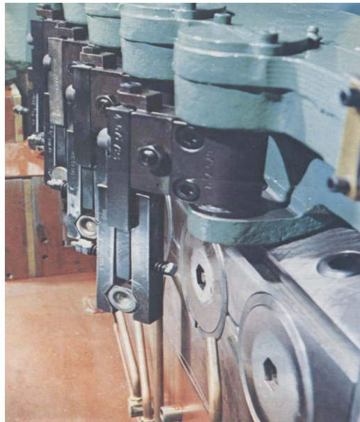
FIG.3-12 MORDAZAS TRANSPORTADORAS CON UNIDADES GIRATORIAS
