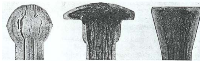
FIG.2-38.RECORRIDO FAVORABLE DE LAS FIBRAS POR DESARROLLO CONVENIENTE DE RECALADO EN DISTINTAS PIEZAS. MICROGRAFÍAS LONGITUDINALES, ATACADAS POR ÁCIDO X 1,5.
