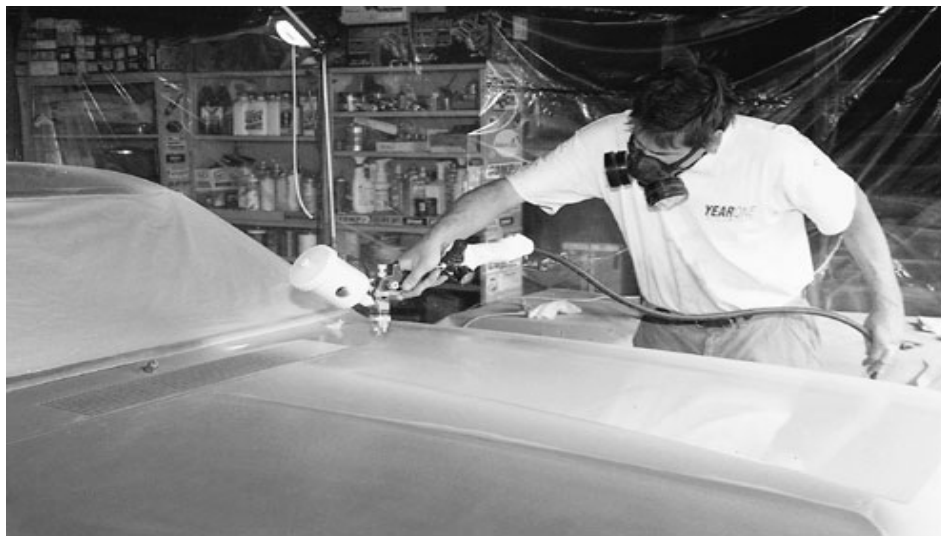
Figura 1.3 Aplicación de pintura automotriz en hojalatería y pintura.
