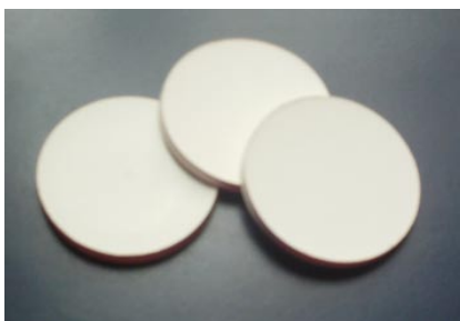
Figura 3.1 Muestras finales de compósitos de silicón RTV-615.
