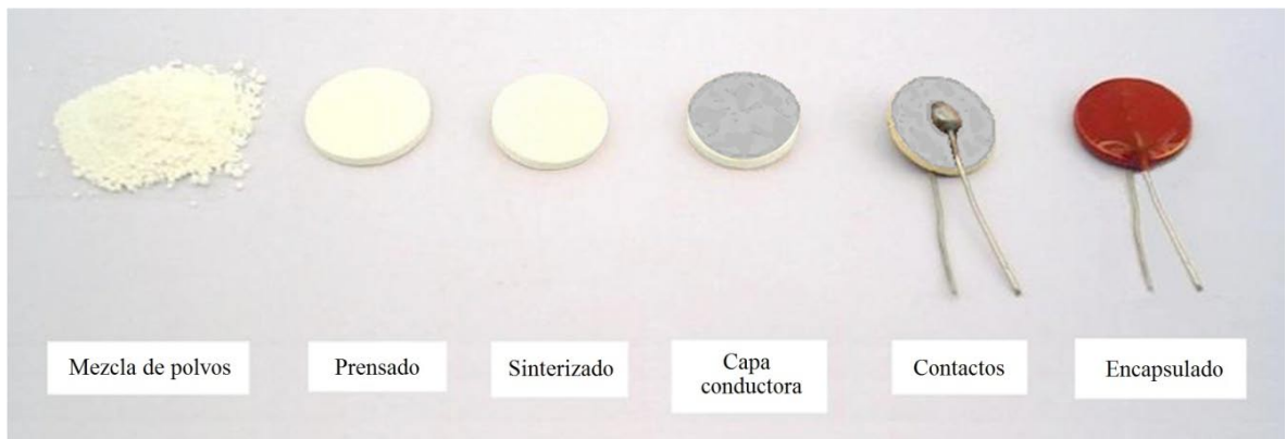
Figura 3.7 Etapas de elaboración de las pastillas capacitivas de \text{BaTiO}_3 para su caracterización eléctrica.
