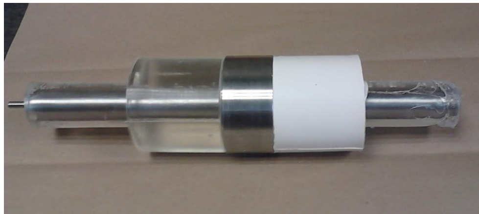
Figura 5.5 Sistema elaborado con una geometría simplificada del extremo a potencial de tierra en una boquilla de transformador de 115 \text{ kV}_{\text{RMS}} . a) Diseño y dimensiones y b) sistema terminado.
