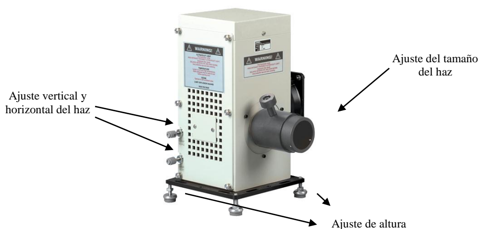
Figura 2.1 Carcasa de la lámpara Newport
