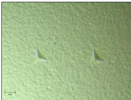
**Figura 11. Huella tipo Berkovich en una membrana de quitosán, sometida a pruebas de nanoindentación con 5 mN de fuerza.**
