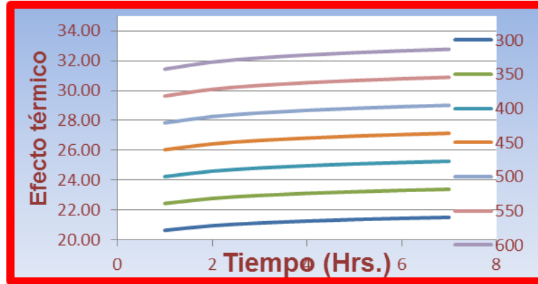
Figura 24 Variación del efecto térmico a diferentes tiempos y temperaturas
