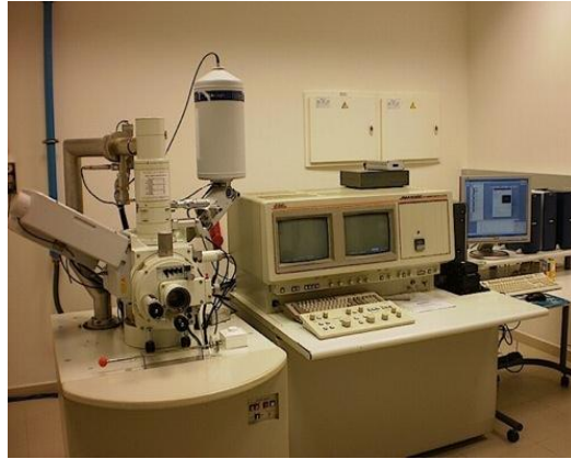
Figura 8 Microscopio Electrónico de Barrido Marca Jeol 6900
