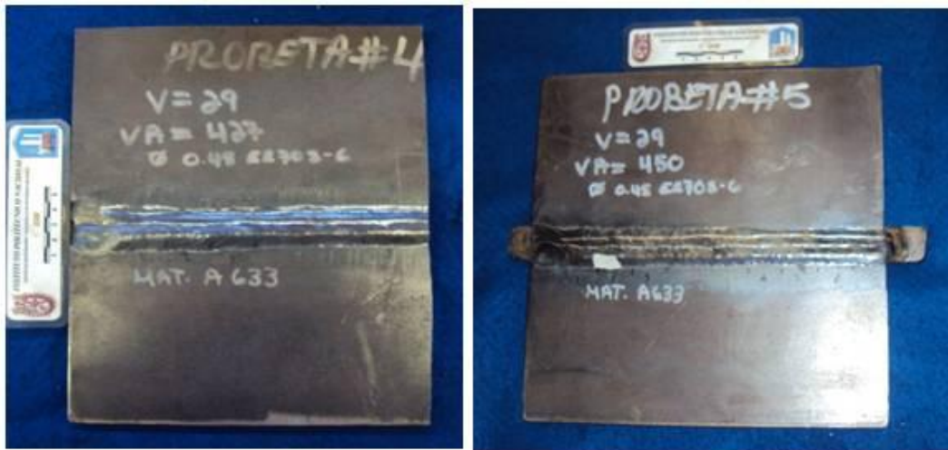
Figura 12 Depósito de cordones con diferentes condiciones como se indico en la tabla 2 probeta A (izquierda) y probeta B (derecha).
