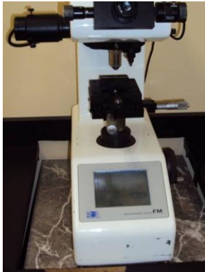
Figura 9 Microdureómetro marca -Tech Microhardness Tester FM
