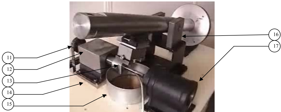
Fig. 4.2 b) Vista en perspectiva del equipo tribológico para desgaste adhesivo de configuración “cilindros cruzados”.
