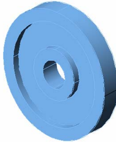
Fig. 3.22 Esquema del contrapeso principal, los detalles de manufactura están indicados en el plano CM 012
