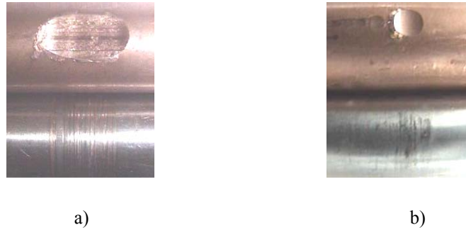
Fig.4.18 Probeta de cobre en la parte superior y probeta de acero AISI 1045 en la parte inferior, a) Desgaste en condición seca, b) Desgaste en condición lubricada.
