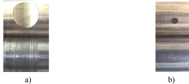
Fig.4.24 Probeta de bronce en la parte superior y probeta de acero AISI 1045 en la parte inferior, a) Desgaste en condición seca, b) Desgaste en condición lubricada.
