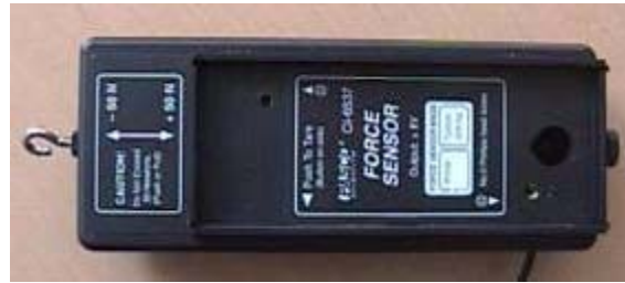
Fig. 4.4 Sensor de fuerza de fricción que consta de un transductor electromecánico.
