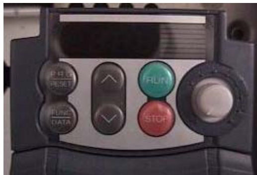
Fig. 4.7 Vista de teclas del inversor de frecuencia.
