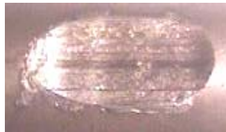
Fig. 4.30 Se manifiesta un desplazamiento de cobre a los lados de la huella de desgaste.
