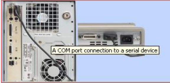
Ilustración 19 Conexión por RS232 a la PC y al equipo de medición.
