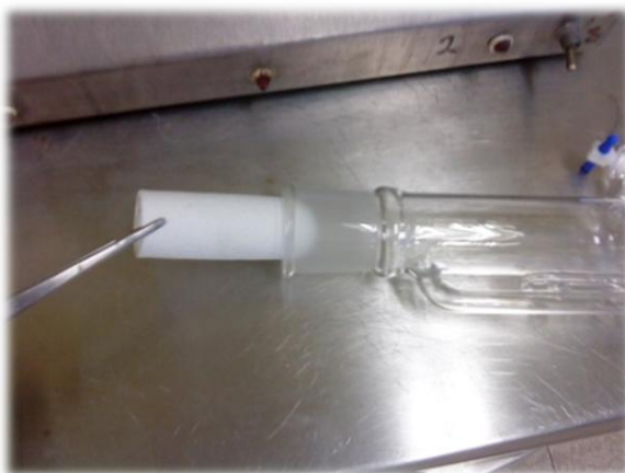
Fig. 4.24 Incorporación del cartucho de celulosa a cámara de extracción.
