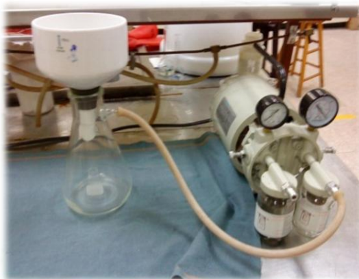
Fig. 4 16 Montaje del sistema de filtración a vacío.
