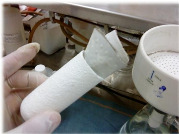
Fig. 4.21 Inserción del medio filtrante dentro del cartucho de extracción de celulosa.
