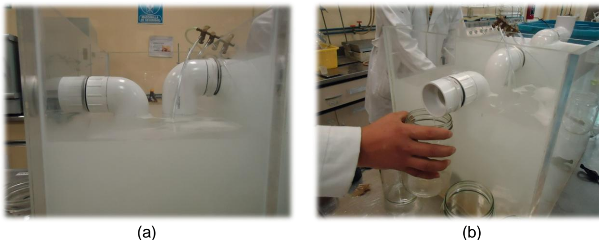
Fig. 4.9 Toma de muestra del efluente. (a) Ajuste de la tasa de aire suministrado; (b) Toma de la muestra E1-00
