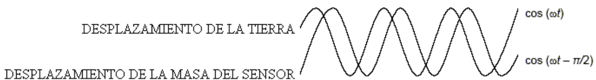
Figura 3.2. Diferencia de fases entre el desplazamiento real y el captado por el sensor.
