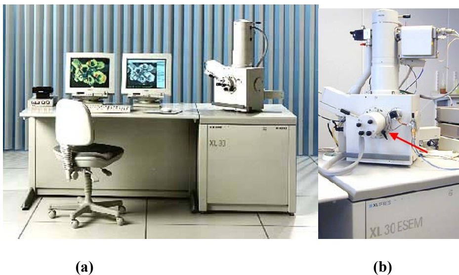
Figura 2.6 Microscopio electrónico de barrido. a) Se muestra el equipo completo, b) detalle del cañón óptico, la flecha indica la cámara donde se colocan las muestras que se desean estudiar.
