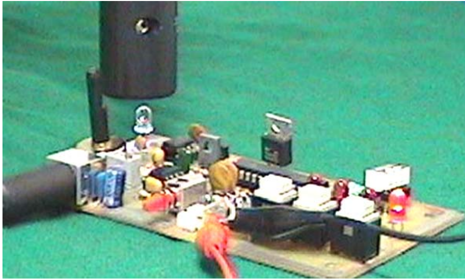
Figura 5.10 Tarjeta de control ensamblada. En la parte superior izquierda se observa el soporte del diodo láser.
