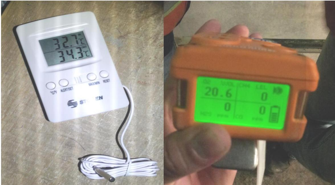
**Fig.12.1. Toma De Temperatura Ambiente, Lectura De Gases, Niveles De Oxígeno En Frente De Excavación**
