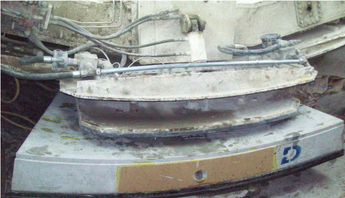
**Fig.8.12. Anillo Erector Succionando Por Medio De Vacío Dovela Cuña Para Su Colocación**
