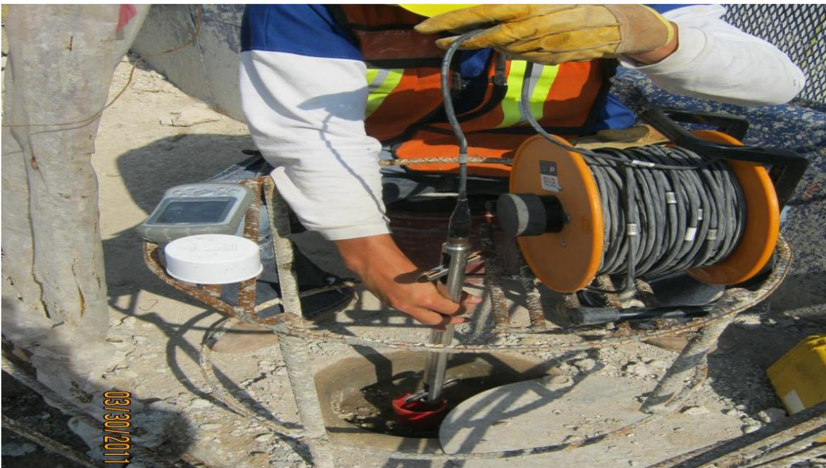
**Fig.11.3. Toma de Lecturas Por Medio De la sonda en Inclinómetro
