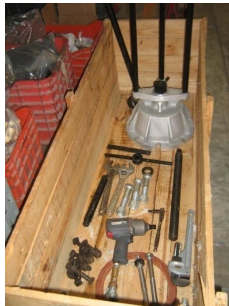
Figura III.2c. Equipo para Hot-tapping. Cortesía de IACMEX/TECSA. 2010.
