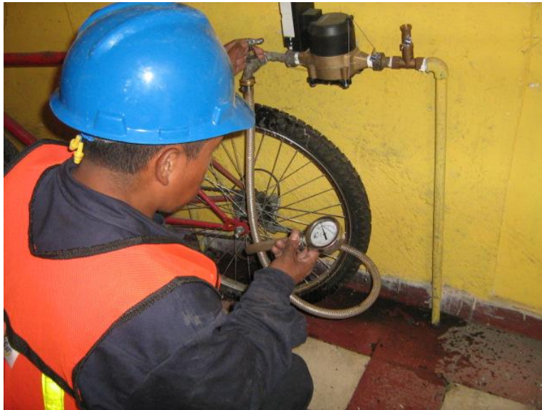
Figura III.2a. Manómetro instalado para medición de presiones en la Delegación Benito Juárez. Cortesía de IACMEX/TECSA. 2009
