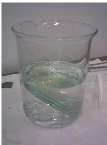
**Figura.3.8.** Sustratos en solución de acetona, alcohol isopropílico y agua destilada.
