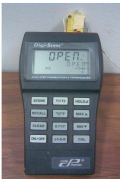
**Figura.3.16.** Termopar digital, marca: Cole Parmer, Digi-Sense
