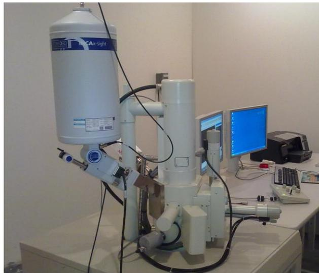
**Figura 3.24.** Microscopio electrónico de barrido Quanta, imagen proporcionada por el Centro de investigación en ciencia aplicada y tecnología avanzada (CICATA).
