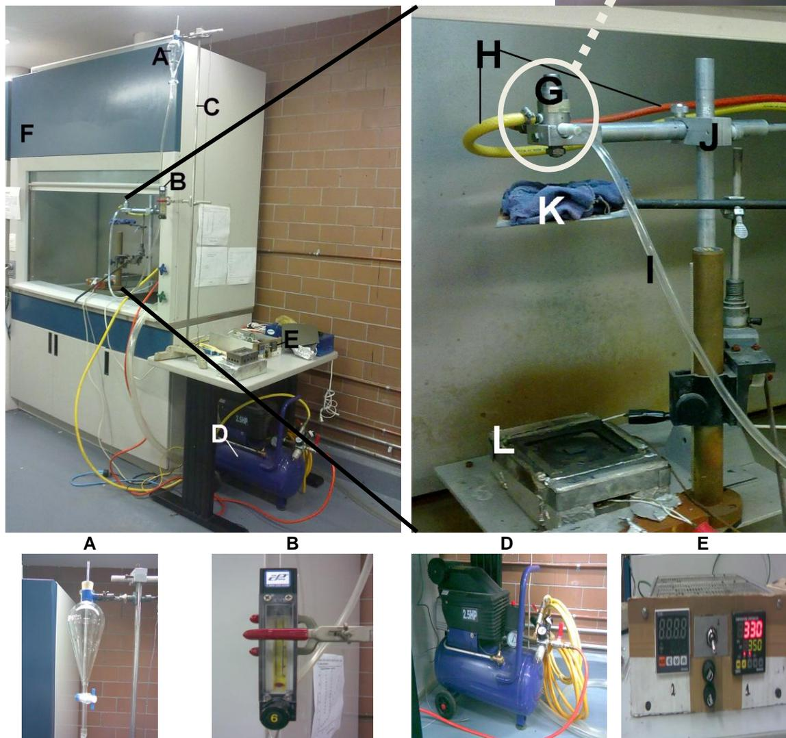
Figura.3.11. Imagen general del sistema de rocío químico y sus componentes.
