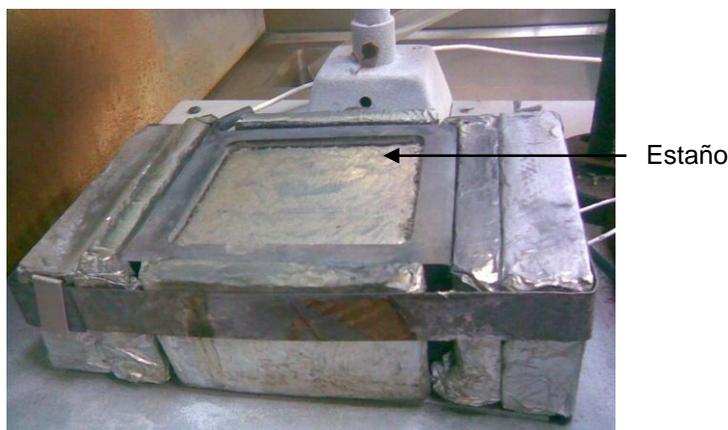
Figura.3.13.Horno con baño de estaño.
