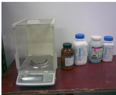
**Figura.3.3.**Balanza analítica digital, marca AND, HR-200 y reactivos usados.
