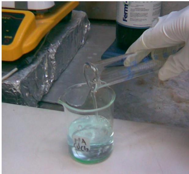
**Figura.3.5.**Preparación de solución de cloruro de cobre.
