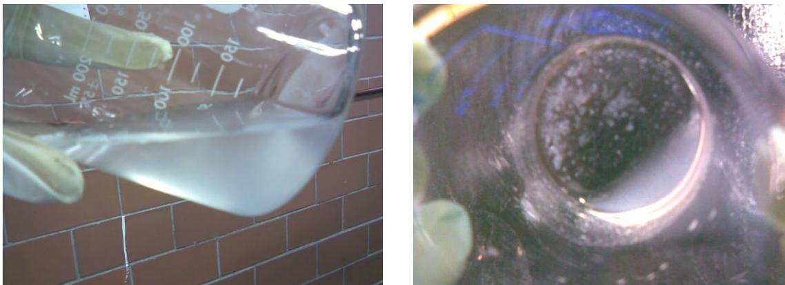
**Figura 3.2.**Formación de precipitado, al mezclar las soluciones en diferente orden.
