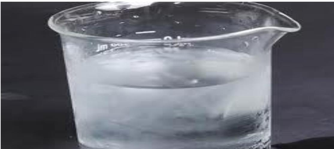
Figura 44. Baño refrigerante mezcla hielo-agua
