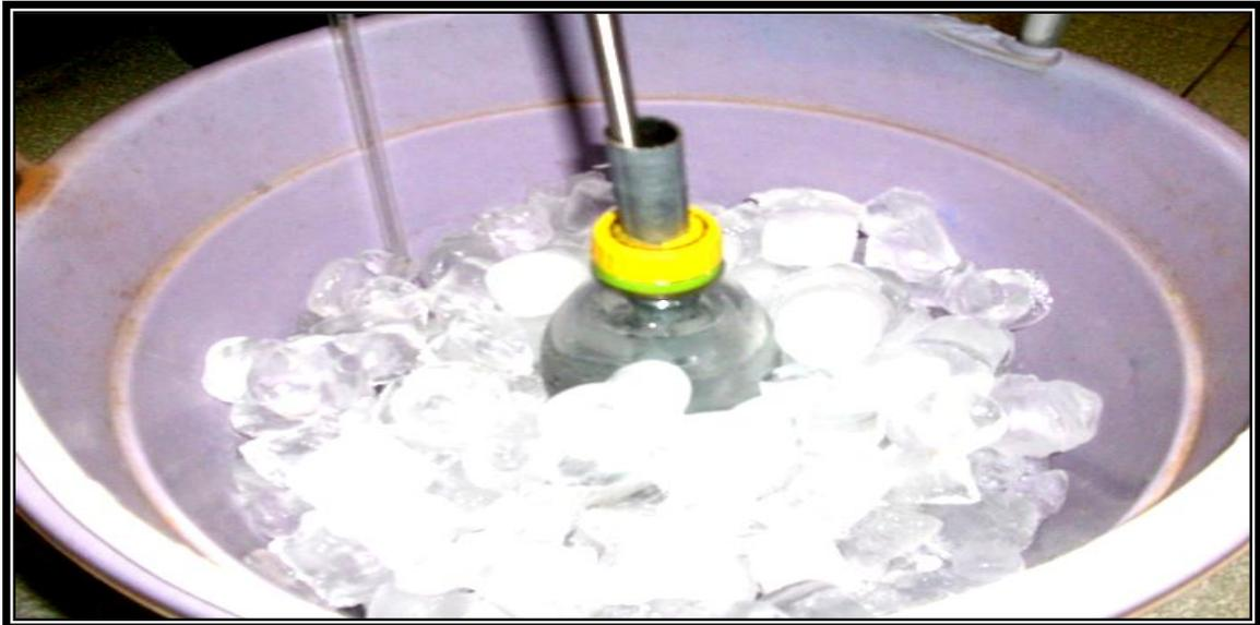
Figura 28. Baño de hielo aplicado a la celda
