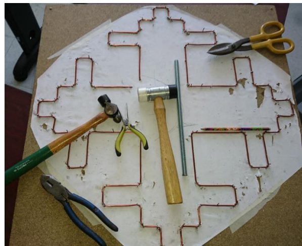
Figura 4.5 Proceso de doblado terminado y material utilizado en el proceso
