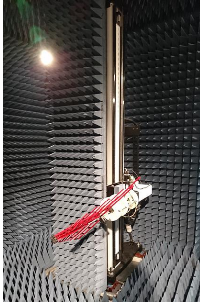
Figura 4.13 Montaje de la antena logarítmica en el mástil de la cámara anecoica.
