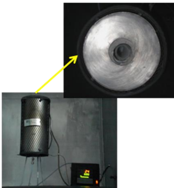
Fig. (14). Vista superior del horno con la salida del reactor de cuarzo.
