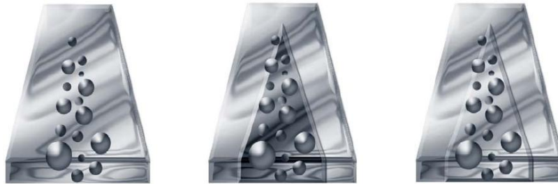
Fig. (1). El oxígeno del medio forma una película protectora de óxido de cromo sobre la superficie del acero inoxidable. (3)
