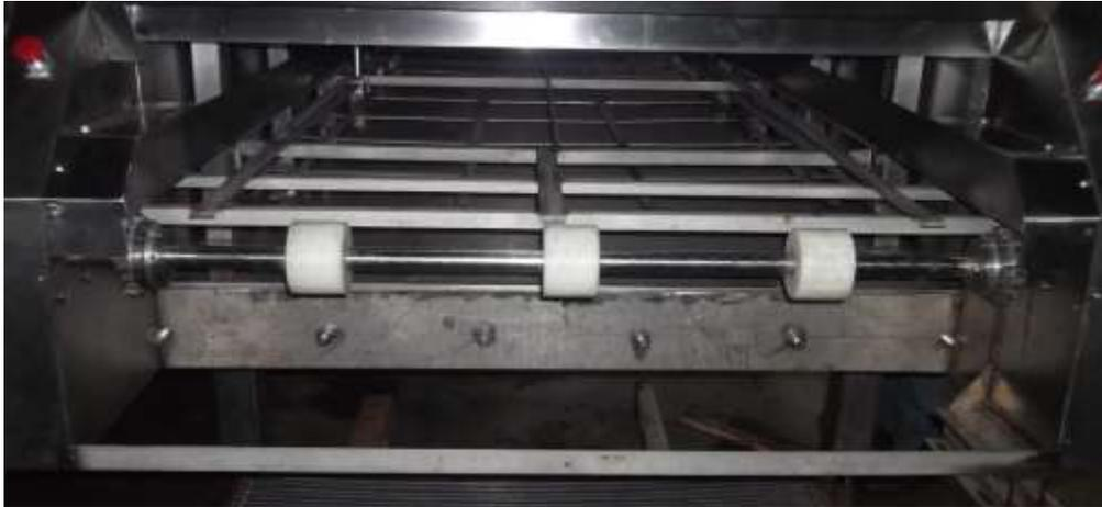
Figura 1.16 Eje giratorio montado entre 2 chumaceras.
