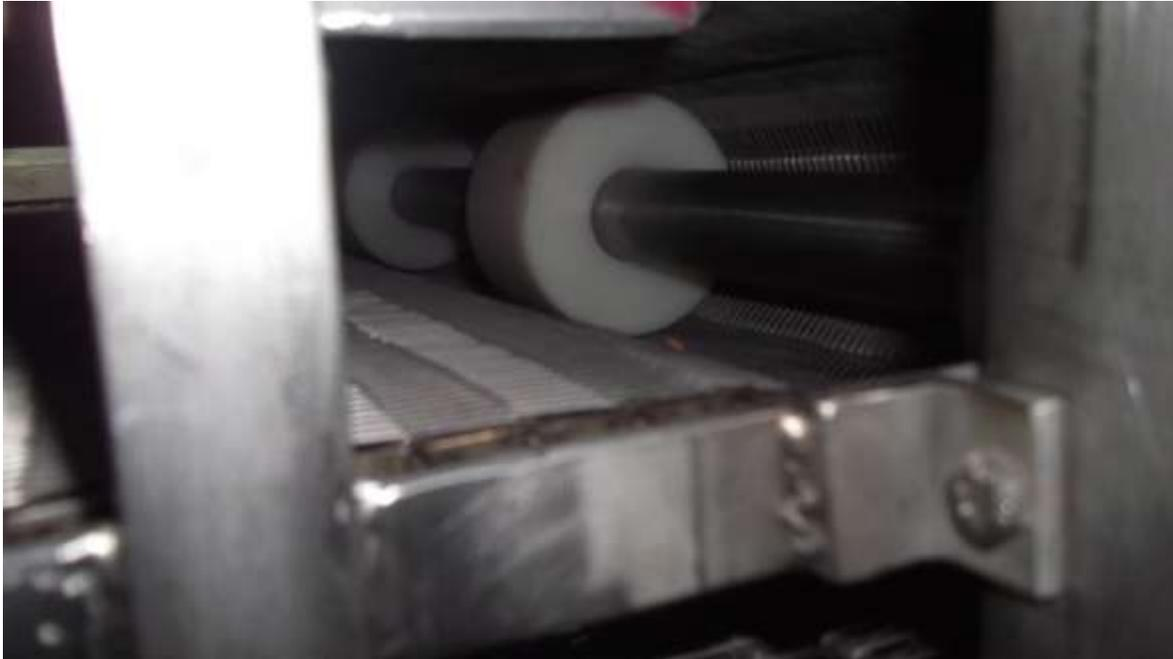
**Figura 1.20 Rodamiento Nylamid montado en eje giratorio de la Banda Transportadora.**
