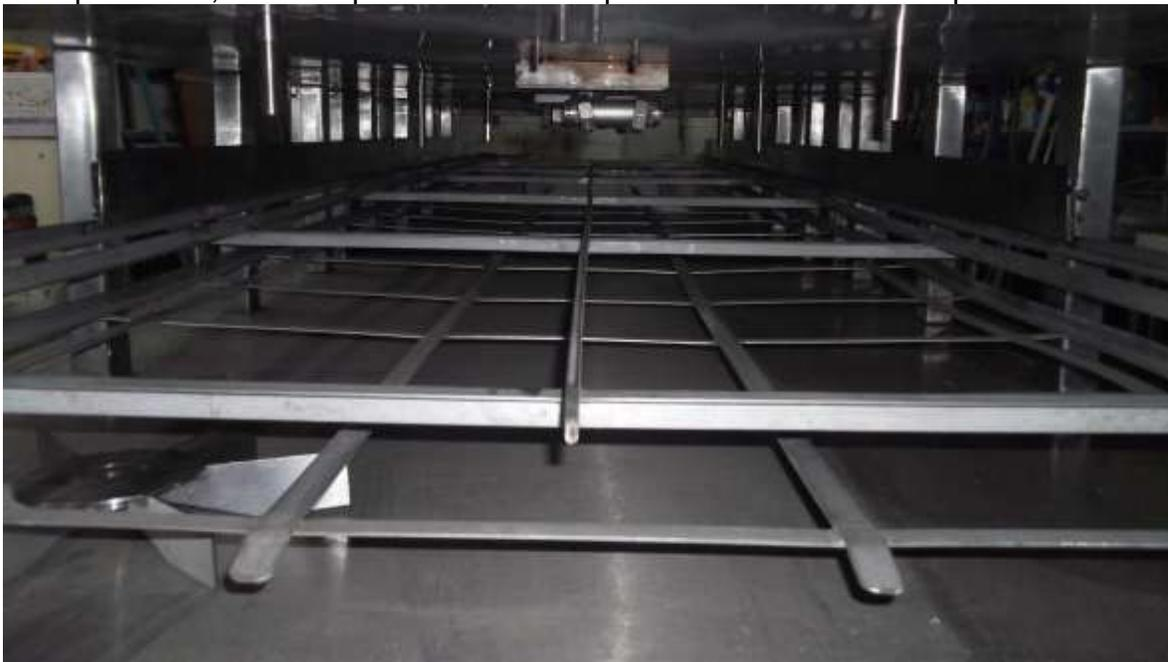
**Figura 1.9 Cama de la banda transportadora.**
