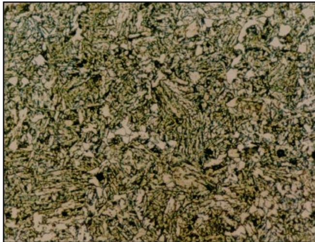
**Figura 25. Metalografía del acero UNS G41400. X 150, ataque químico con Nital.**
