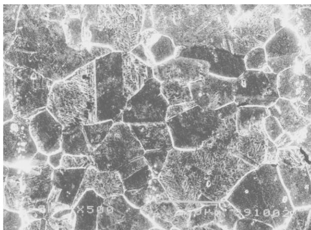
**Figura 50. Metalografía del acero inoxidable 316 en la dirección transversal.**
