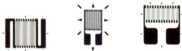
**Figura 1. Algunos modelos de galgas o strain gages que son utilizados en la actualidad.**
