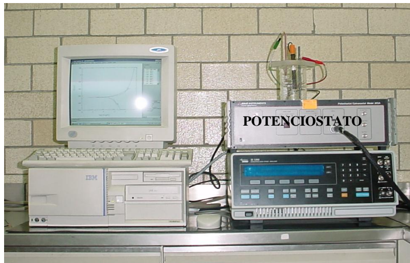
Figura 2.3 Computadora con el programa 352 SoftCorr III y Potenciostato utilizados en las Etapas I, II y III.
