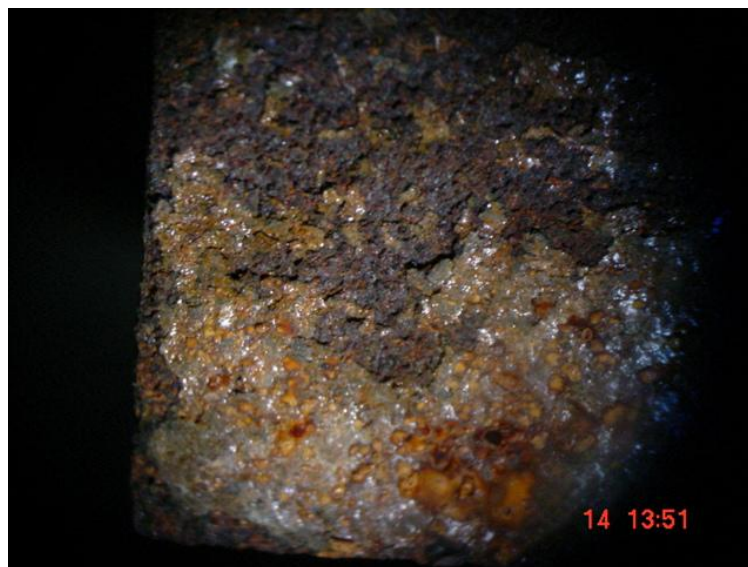
Figura 3.29 Fotografía que muestra el ataque a la superficie del electrodo de trabajo. Medio deaerado donde están presentes el CO_2 y el H_2S y la especie dominante fue el H_2S .
