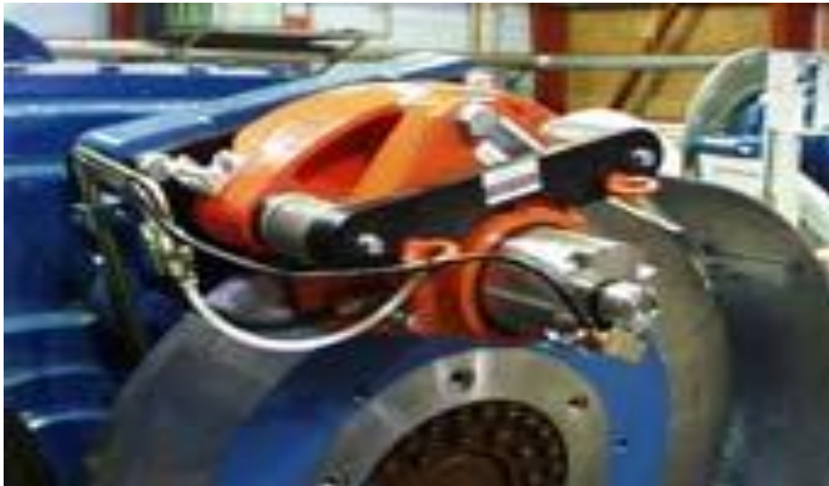
Fig.-4. 4 Freno mecánico del aerogenerador.
