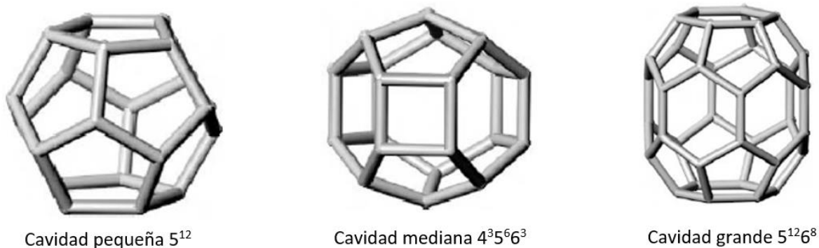
Figura I.6 Cavidades que conforman la estructura sH. [1]
