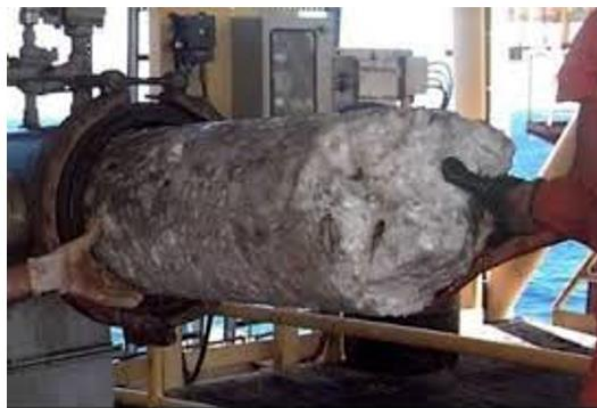
Figura I.1 Taponamiento de una tubería causado por la formación de hidratos (Petrobras).
